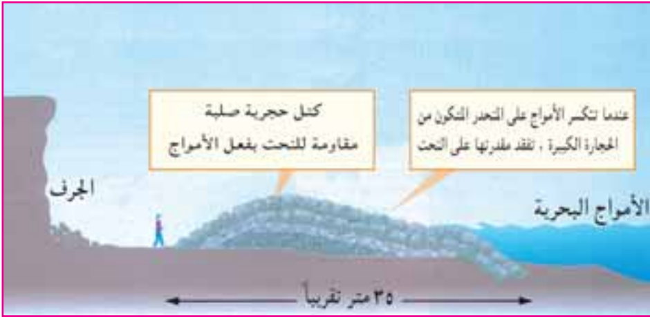
شكل (٣١) مقطع يبيّن الكتل الحجرية لحماية الشاطئ من التآكل
